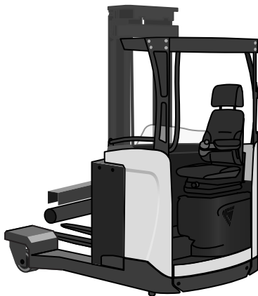
Fig. 4. Carretilla con mástil retráctil de cuatro vías
