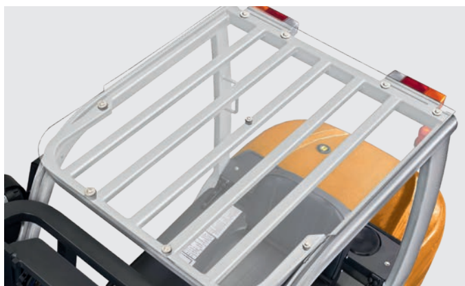
Las finas barras del techo protector garantizan la máxima seguridad y una visibilidad óptima
