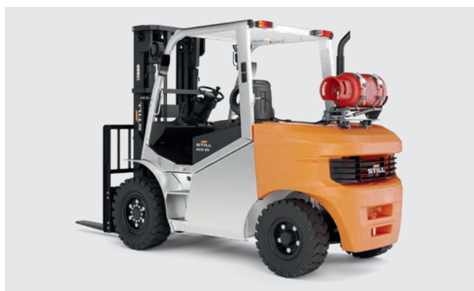
Sustitución ergonómica de botellas: soportes abatibles y giratorios disponibles para diferentes tipos de botellas de gas propulsor
