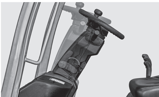
La columna de dirección, totalmente ajustable, permite a cada operario seleccionar la posición de conducción más cómoda
