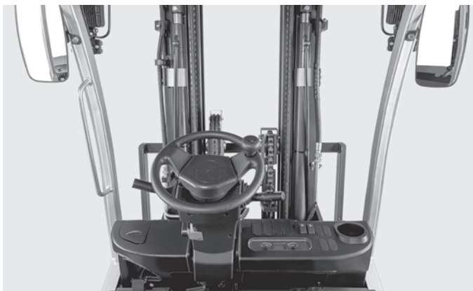
La buena visibilidad a través del mástil permite una mayor seguridad y una alta rotación
