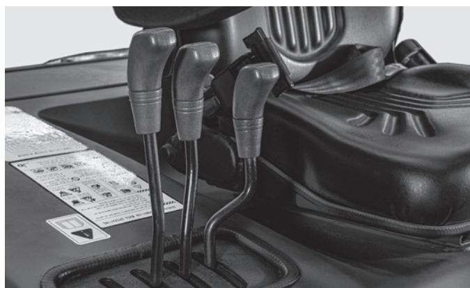
Los mandos multipalanca otorgan al operario el máximo control al utilizar el sistema de elevación hidráulica
