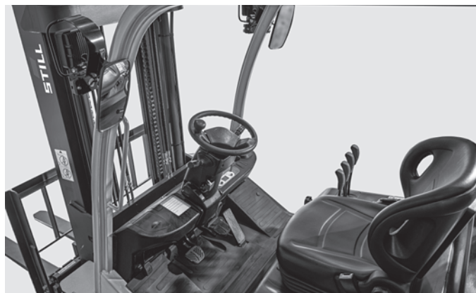
De diseño ergonómico, la plataforma del operario es espaciosa y está muy bien organizada, con controles operativos intuitivos
