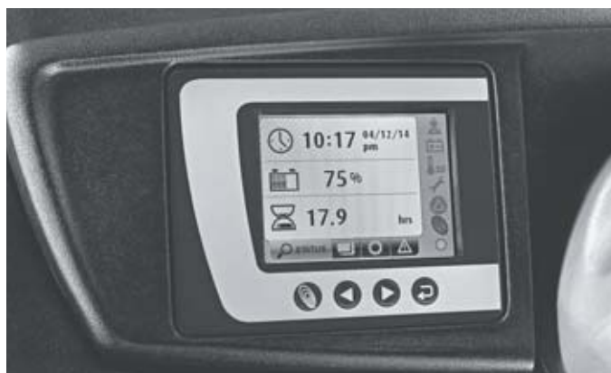
La unidad de control y visualización a color indica el estado de la batería, el sentido de la marcha e información adicional
