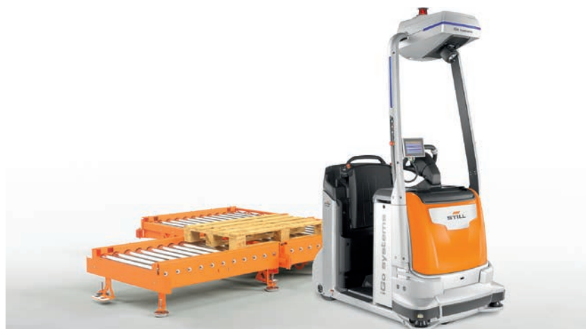
Los LTX 50 iGo systems combinan desplazamiento y manipulación de la carga automatizados
