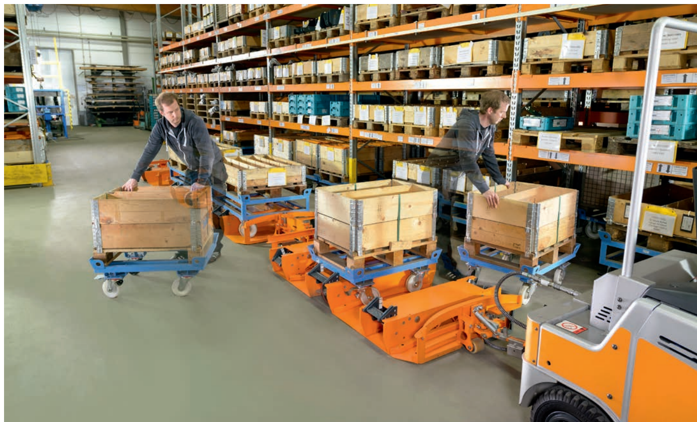
Es posible transportar diferentes clases de unidades de carga con el chasis B
